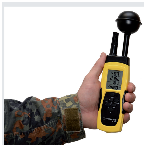
Abb. 2: Beispiel eines marktverfügbaren Klimamessgerätes, mit dem die Wet Bulb Globe Temperature (WBGT) als Klimaauswertemaß zur Beurteilung des aktuellen lokalen Klimas bestimmt werden kann.
